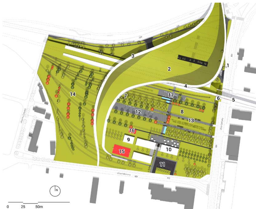
Ryc. 4. Plan zagospodarowania rejonu dworca Poznań-Garbary: 1 – zadaszony węzeł komunikacyjny (dworzec kolejowy, autobusowy, taxi, rowery miejskie), 2 – zielony dach, 3 – ścieżka pieszo-rowerowa, 4 – taras widokowy, 5 – kładka dla pieszych, 6 – pylon z klatką schodową, 7 – strefa usług, 8 – trawnik, 9 – zaplecze sportowe, 10 – strefa gastronomiczna, 11 – parking, 12 – strefa reprezentacyjna, 13 – strefa wypoczynkowa, 14 – strefa parkowa, 15 – boisko sportowe, 16 – plac zabaw, 17 – plac przed dworcem (obszar nr 2 na ryc. 1). Źródło ilustracji: N. Moskalik, 2013
